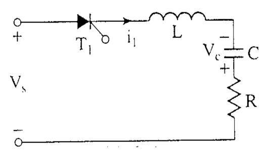
$$L\frac{di_{1}}{dt} + Ri_{1} + \frac{1}{C}\int i_{1}dt + v_{C}(0) = V_{S}$$
