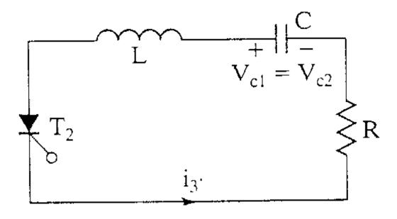
$$L\frac{di_3}{dt} + Ri_3 + \frac{1}{C} \int i_3 dt + v_{C_3}(0) = 0$$
